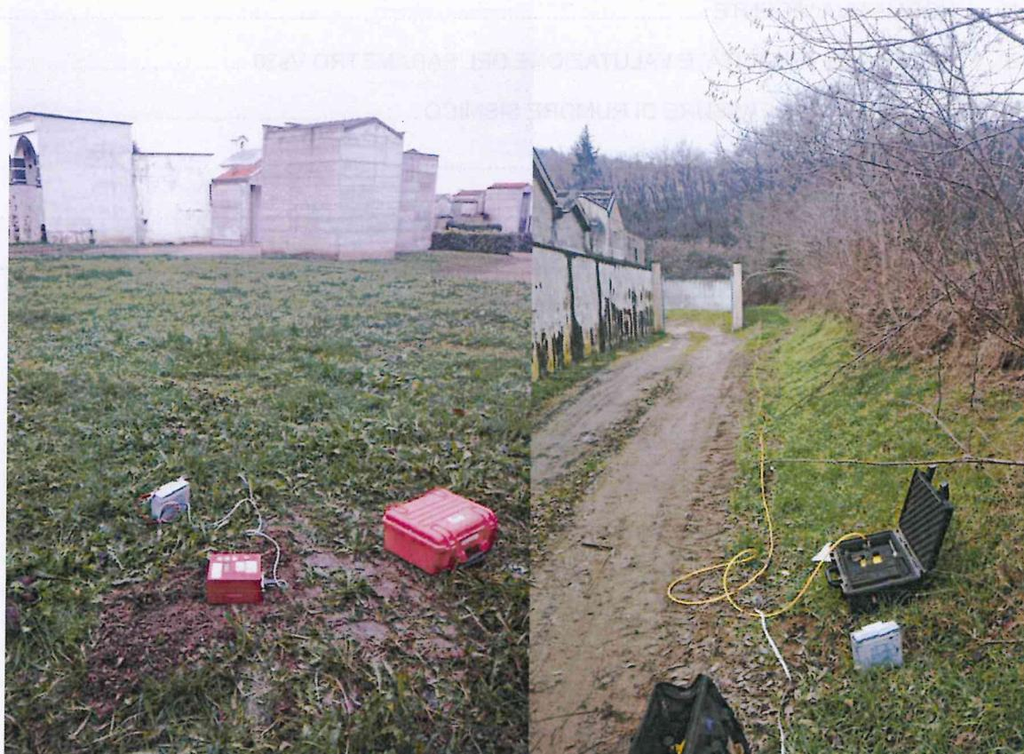
**Indagine sismica con metodologia MASW e misure di rumore sismico
