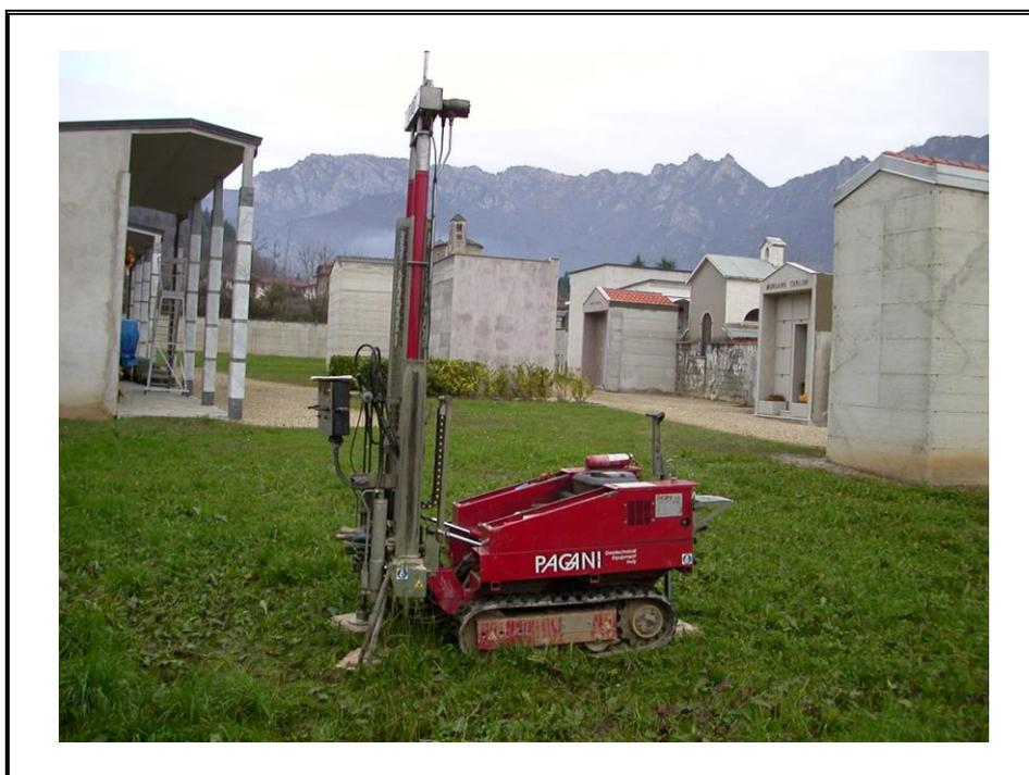
**Foto 2:** Posizionamento prova penetrometrica dinamica P2.
